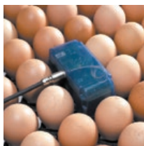
OvoScan™ para temperaturas de incubación óptimas
