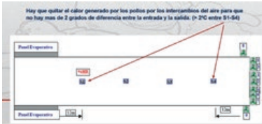
Figura 8. Con altas densidades esto podría mantener no mas de 2 °C de subida desde la entrada hasta la salida.
